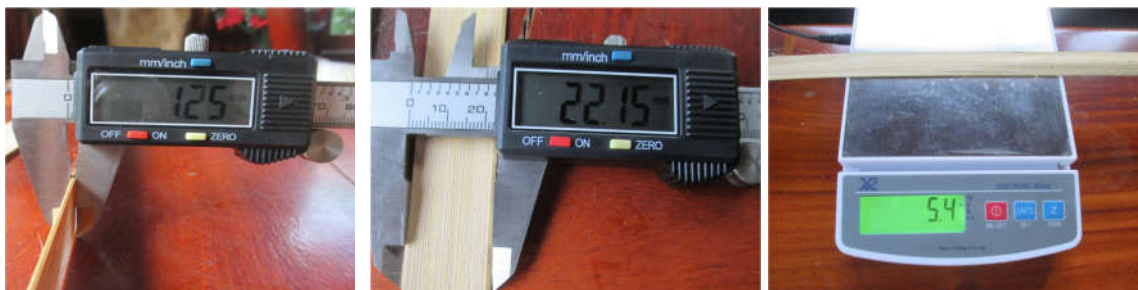
Hình 3. Các phép đo cân kiểm tra thông số công nghệ của nan cơ sở từ cây lồ ô
