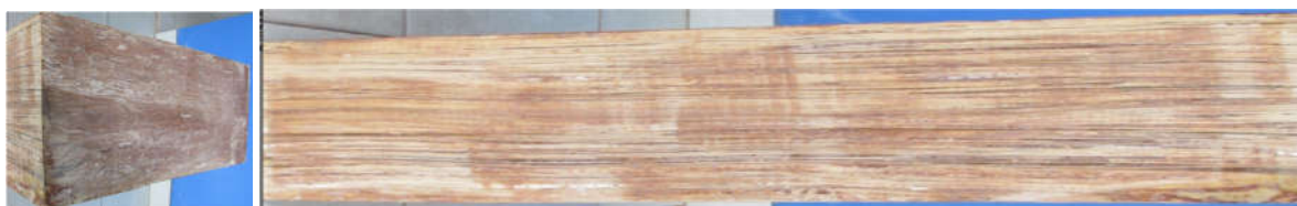
Hình 5. Ván ép khối bằng nan cơ sở từ cây lồ ô
