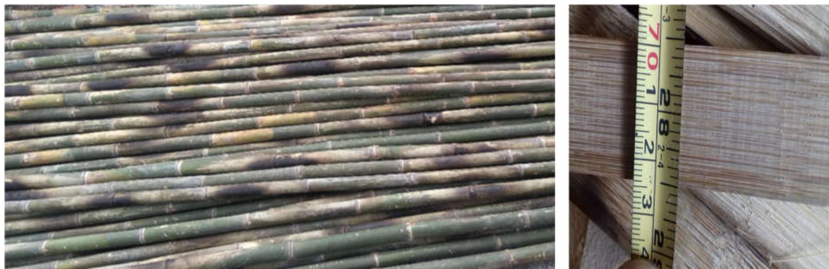
Hình 4. Cây tầm vông và chiều rộng thanh cơ sở làm từ cây tầm vông
