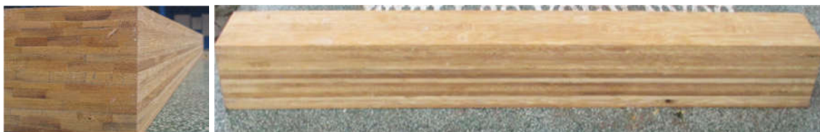
Hình 6. Ván ép khối được tạo bằng thanh cơ sở từ cây tầm vông
