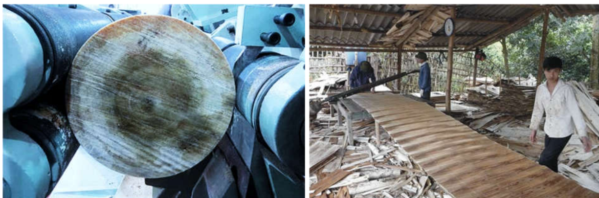
Hình 4. Bóc ván mỏng bằng máy không trục châu và băng ván mỏng
