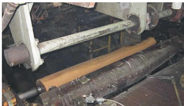
Hình 3. Trục chấu và máy bóc ván mỏng có trục chấu
