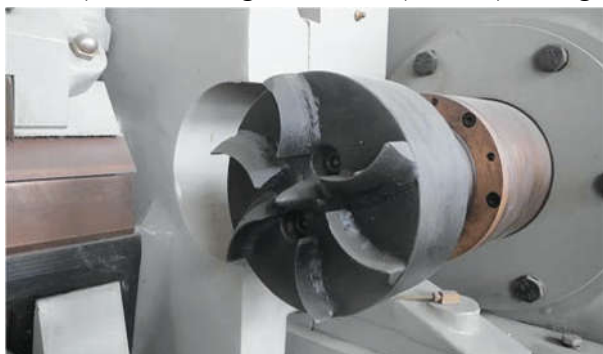
Hình 3. Trục chấu và máy bóc ván mỏng có trục chấu
