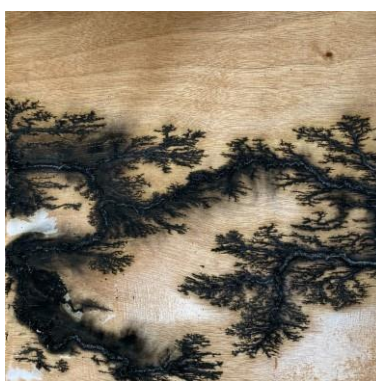
Mẫu xử lý bằng dòng 3000 V trước khi làm sạch bề mặt
