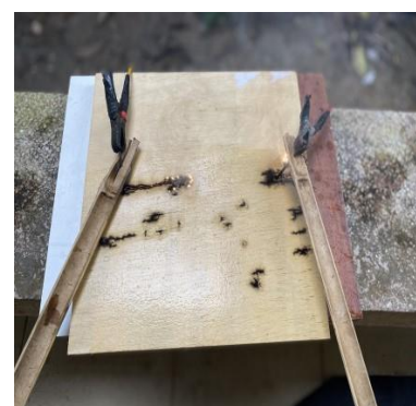
(c) Xử lý bằng dòng điện 2000 V
