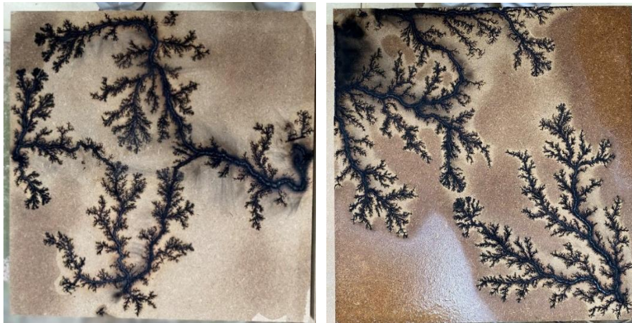
Hình 5. Trang sức hoa văn bằng dòng điện cao thế trên vật liệu ván MDF
