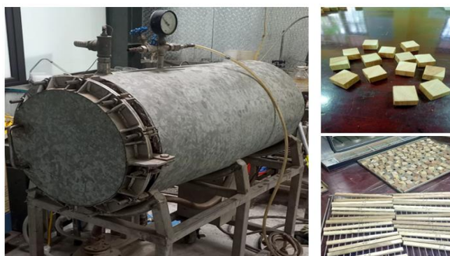
Hình 1. Thiết bị ngâm tẩm chân không áp lực và mẫu gỗ Keo lai dùng để biến tính
