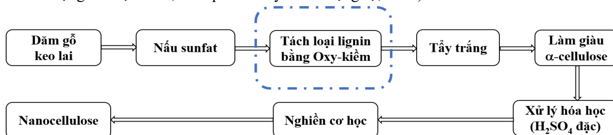
Hình 1. Quy trình công nghệ sản xuất vật liệu Nanocellulose từ gỗ Keo lai
