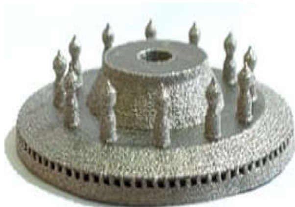
Hình 1. Hình dạng bên ngoài bề mặt của cái kẹp hình kim được tạo ra bằng phương pháp nung chảy laser chọn lọc
