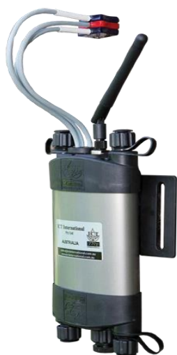
Hình 1. Thiết bị SFM1 Sap Flow Meter Hình 2. Hai cây Giáng hương mang thiết bị SFM1C03 và SFM1C08
