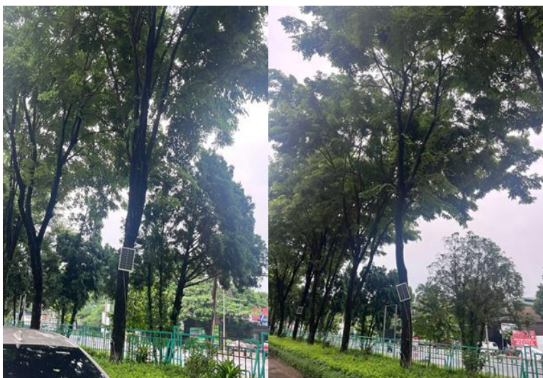
Hình 1. Thiết bị SFM1 Sap Flow Meter Hình 2. Hai cây Giáng hương mang thiết bị SFM1C03 và SFM1C08
