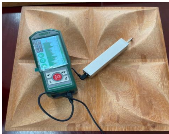
Hình 3. Thiết bị đo độ nhám bề mặt INSIZE ISR-C300
