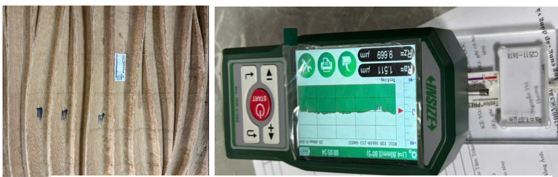
Hình 4. Đo độ nhám bề mặt bằng phương pháp băng keo
