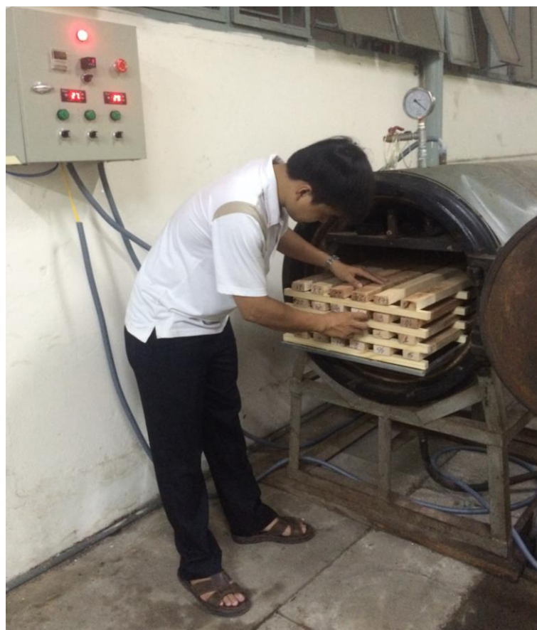
Hình 1. Kiểm tra gỗ trước khi sấy
