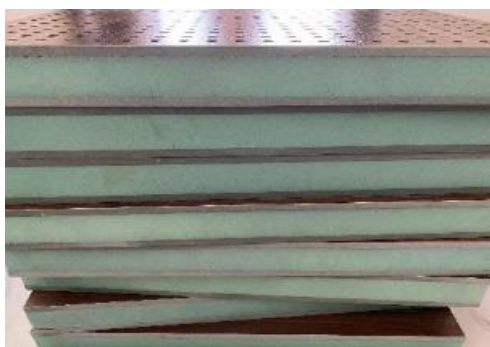
Hình 3. Sản phẩm vật liệu composite 3 lớp dạng tấm nhẹ dùng trong công trình kiến trúc
