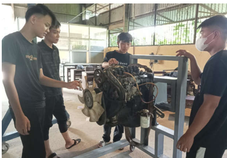
Hình 8. Giá đỡ - xoay tháo lắp động cơ ô tô được ứng dụng trong thực tiễn
