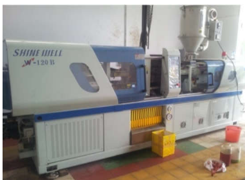
Hình 02. Máy ép phun SW-120B và mẫu thử kéo, uốn
