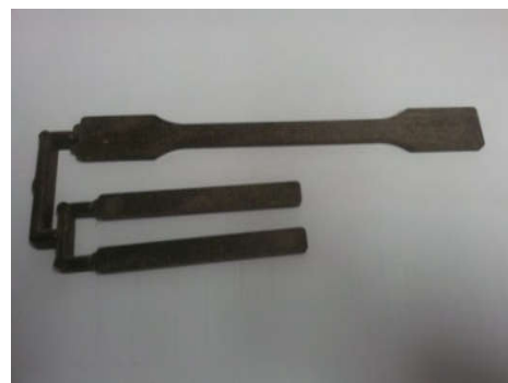
Hình 02. Máy ép phun SW-120B và mẫu thử kéo, uốn
