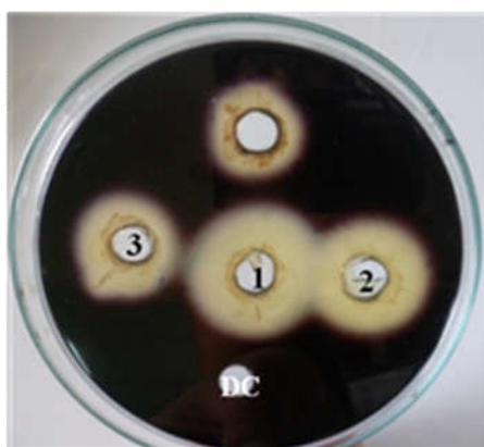
Hình 3.2. Hoạt tính amylase của 3 chủng vi khuẩn lactic: 1-NH10; 2-ND5; 3-NC7; DC- Đối chứng
