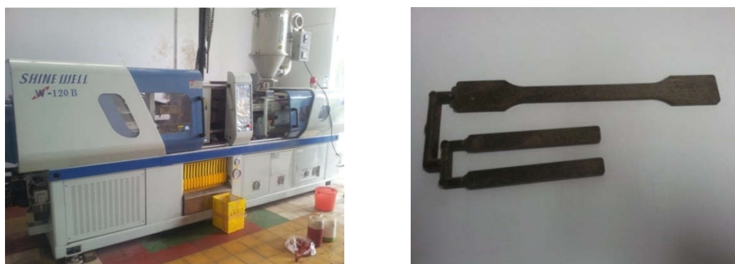
Hình 02. Máy ép phun SW-120B và mẫu thử kéo, uốn
