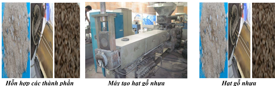
Hình 01. Quá trình tạo hạt gỗ nhựa
