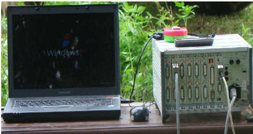
Hình 05. Thiết bị thu thập, khuếch đại thông tin đo lường DMC Plus kết nối máy tính
