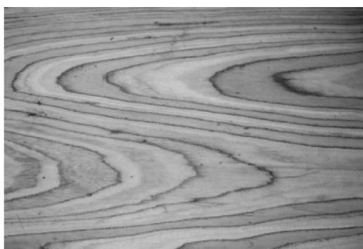
Hình 4. Ván lạng kỹ thuật sản xuất từ gỗ Bò đê và Keo tai tượng
