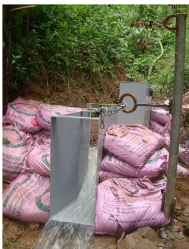
Hình 01. Máng tôn dùng để đo dòng chảy và chất lượng nước lưu vực
