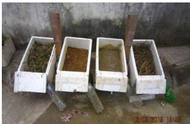
Hình 2. Cách bố trí thí nghiệm để quan sát dòng chảy và xói mòn
