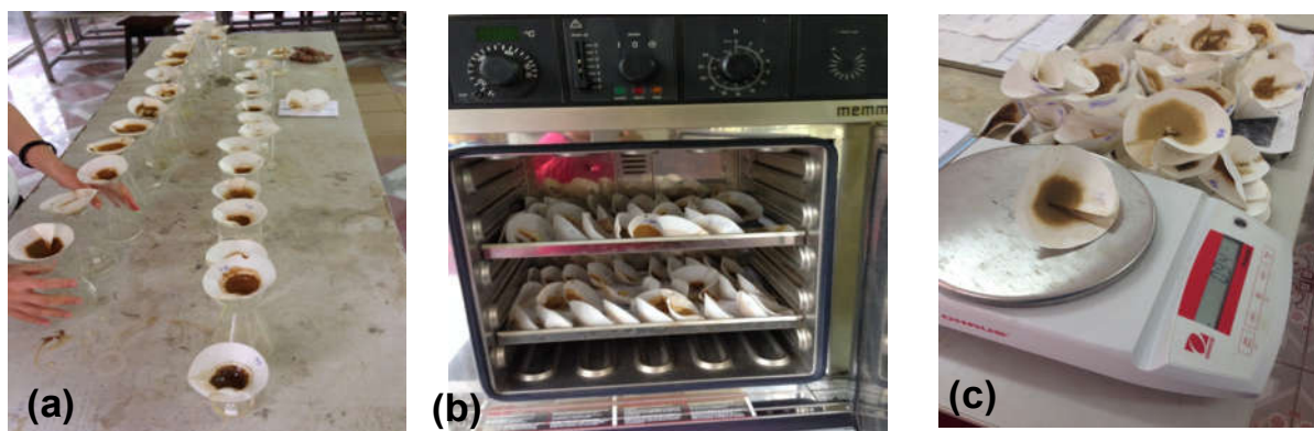
Hình 3. Quy trình xác định lượng đất xói mòn trong phòng thí nghiệm a- Lọc đất; b- Sấy đất; d- Cân đất
