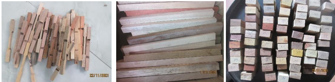
Hình 1. Mẫu thử tính chất cơ học và vật lý gỗ
