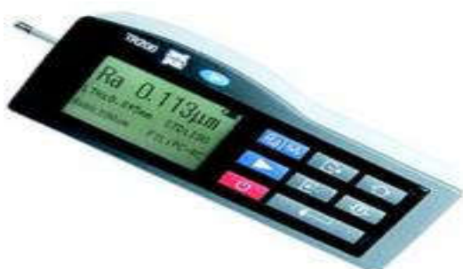
Hình 01. Máy đo độ nhám bề mặt mẫu gỗ
