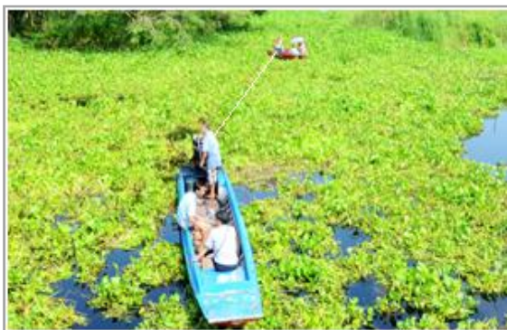
Hình 5. Thí nghiệm đo hệ số cản chuyển động của xuồng chữa cháy
