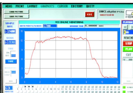
Hình 6. Thí nghiệm đo góc nghiêng ngang của xuồng chữa cháy
